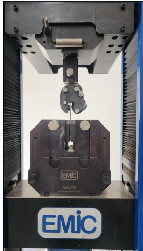
No se registró rotura ni deslizamiento de la chapa en el sistema de apriete de la pinza.
